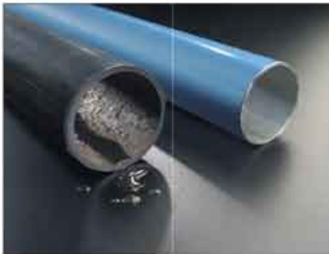
*I sedimenti abrasivi di olio, sottoprodotti del processo di compressione, possono provocare la corrosione della rete delle tubazioni. Ciò può ridurre la durata dell'apparecchiatura e facilitare la formazione di eventuali perdite.*
